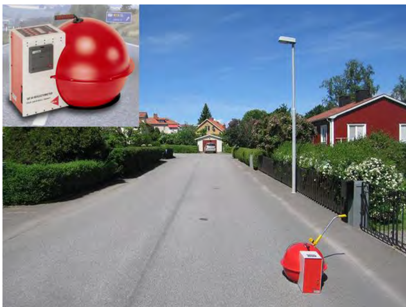
Figur 2 Exempel på mätning av luminanskoefficient. Den infällda bilden visar reflektometern Qd30.
