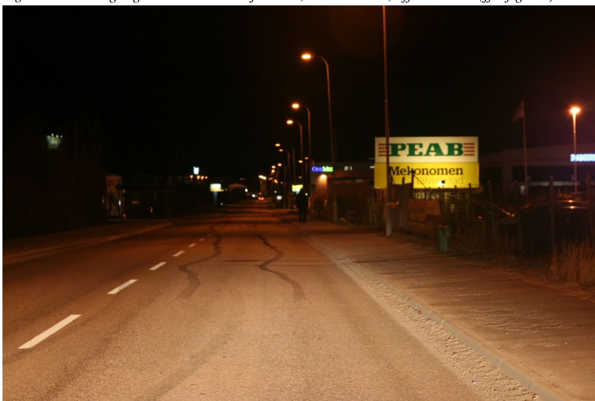
Figur A8 Fotgängare strax bakom ljuskälla, svart klädsel, effekt 65 % (jfr. figur 5)
