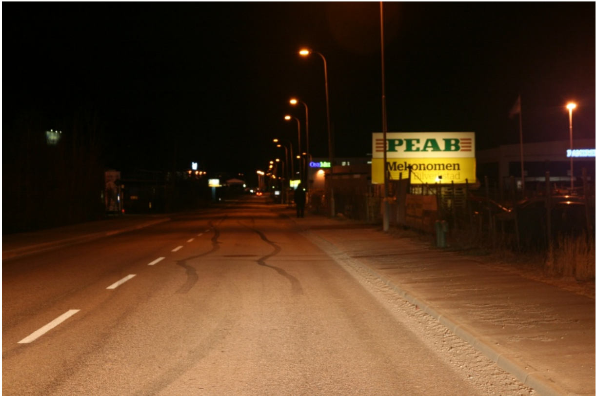
Figur A17 Fotgängare strax bakom ljuskälla, svart klädsel, 65 % effekt på samtliga (jfr. figur 12)
