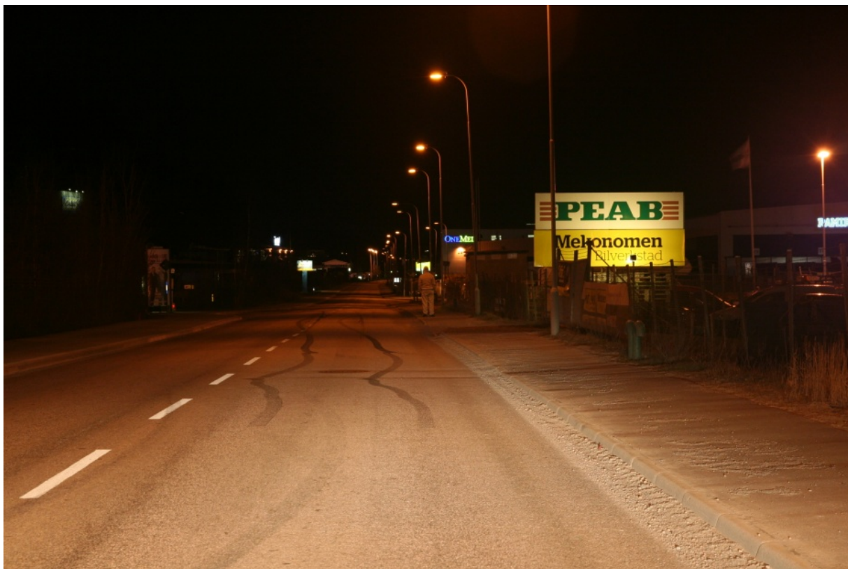
Figur A13 Fotgängare strax bakom ljuskälla, ljusgrå klädsel, 65 % effekt på samtliga (jfr. figur 10)
