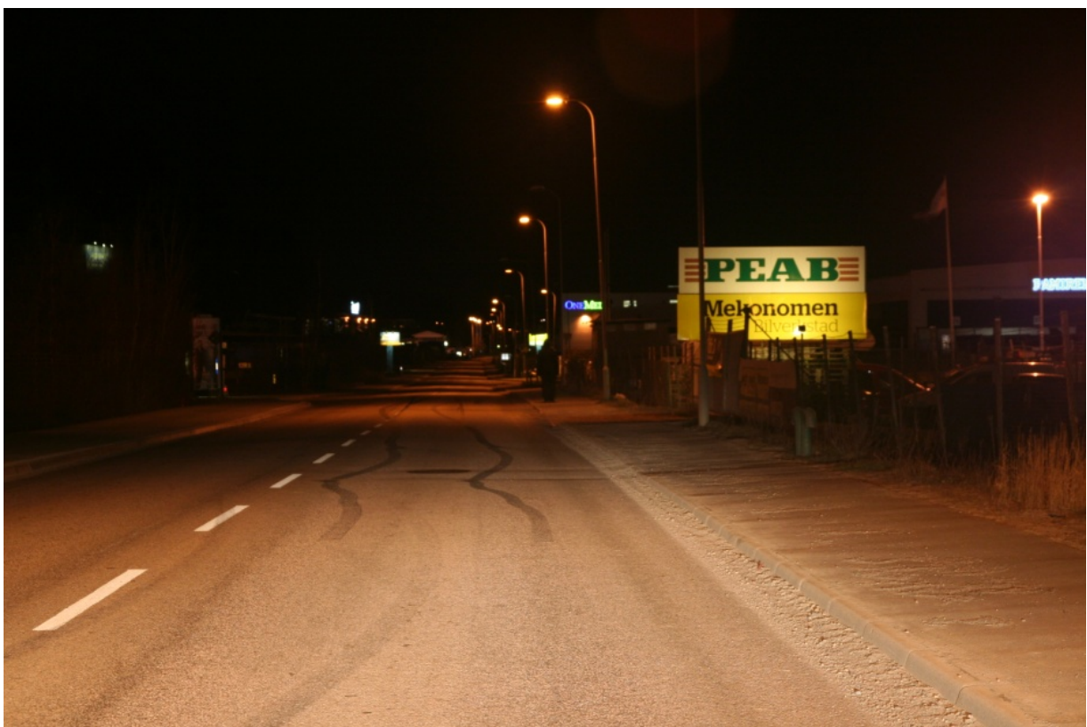
Figur A18 Fotgängare strax bakom ljuskälla, svart klädsel, 100 % effekt på varannan (jfr. figur 12)
