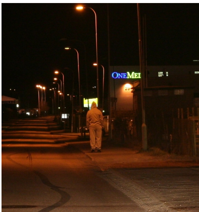
Figur 1 Försökspersonens position på trottoaren. Ljuskällan bakom fotgängarens huvud var släckt under mätningarna.
