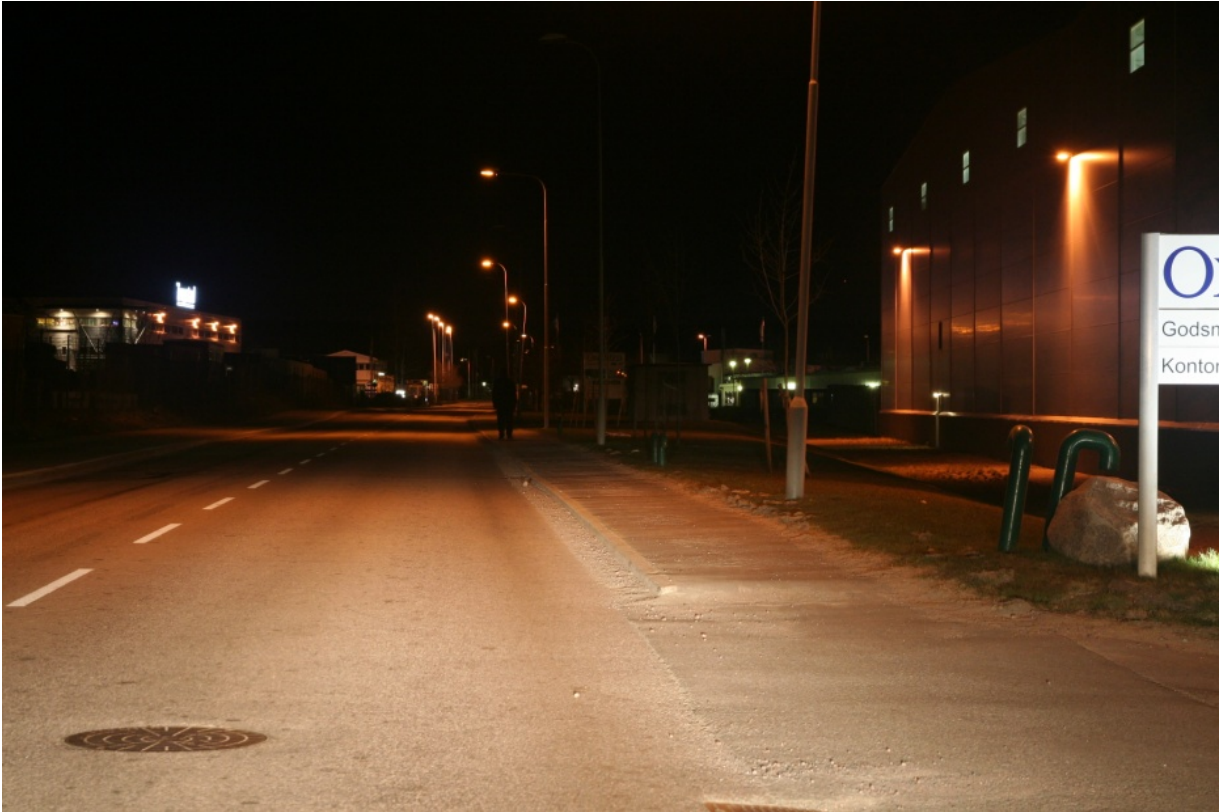
Figur A19 Fotgängare mellan två ljuskällor, svart klädsel, 65 % effekt på samtliga (jfr. figur 13)
