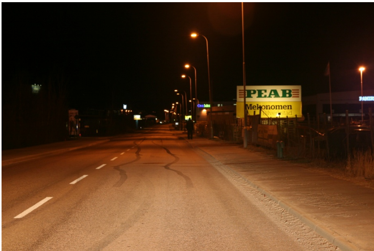
Figur A7 Fotgängare strax bakom ljuskälla, svart klädsel, effekt 100 % (jfr. figur 5)
