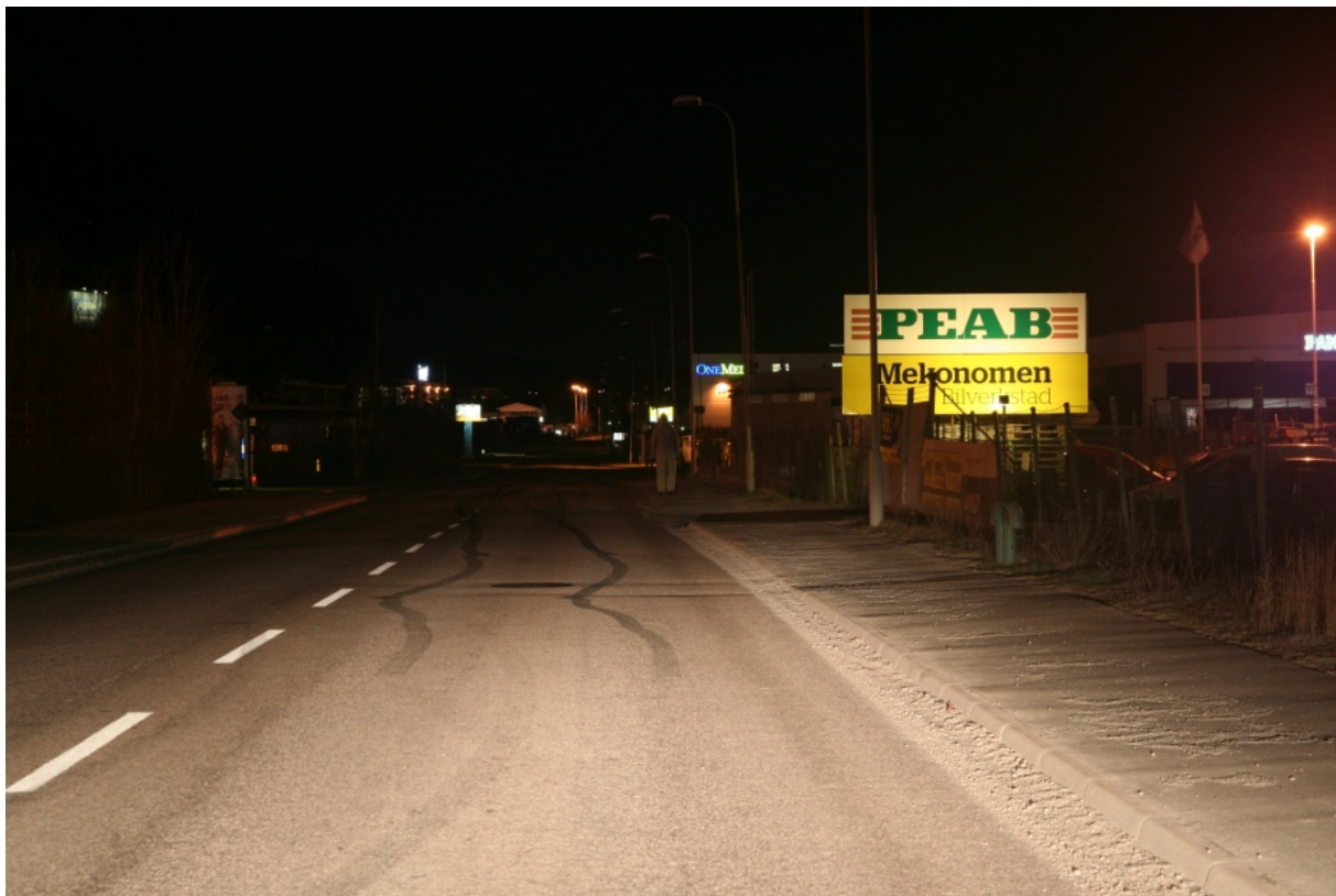
Figur A5 Fotgängare strax bakom ljuskälla, ljusgrå klädsel, ingen belysning (jfr. figur 3)
